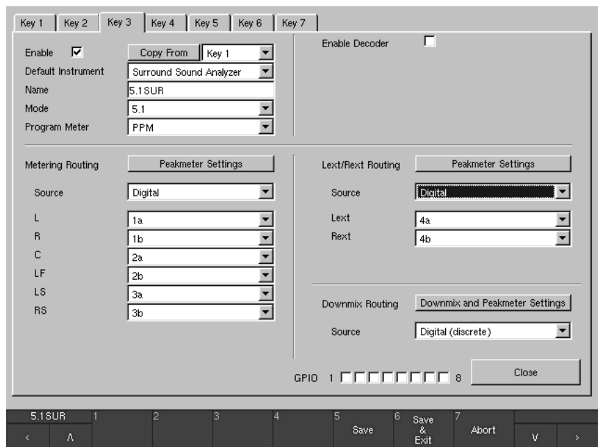
Bild 6-16: Die Menü-Karteikarten „Key 1“ bis „Key 7“ nach dem Drücken der Schaltfläche „Input Routing“ (Aussehen ist abhängig vom gewählten Format)
